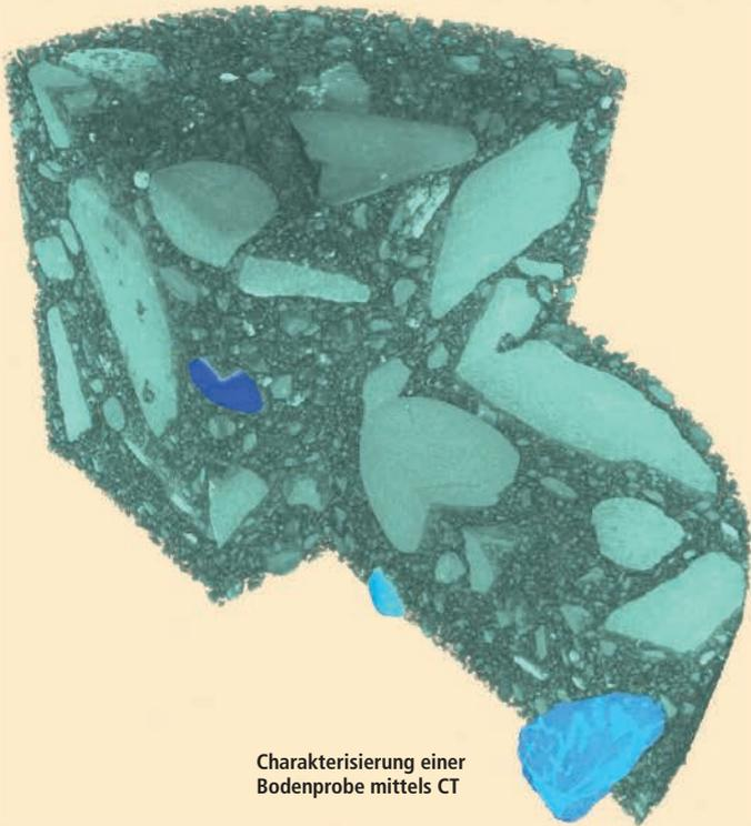
Charakterisierung einer Bodenprobe mittels CT
